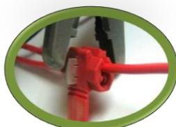
Réaliser la connexion à l'aide d'une pince en exerçant une légère pression
