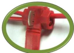
Placer les cables dans le connecteur
