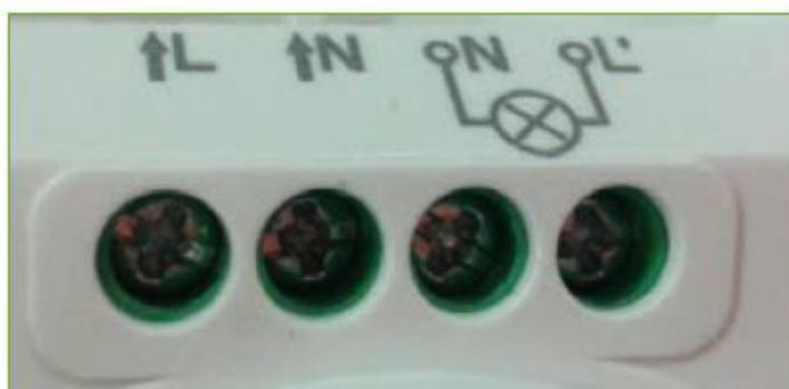
Bornes pour le raccordement du câblage.
