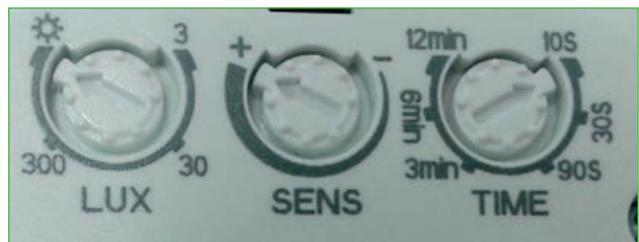
Dispose de sélecteurs ajustables de temps et de luminosité et de réglage de la distance de détection
