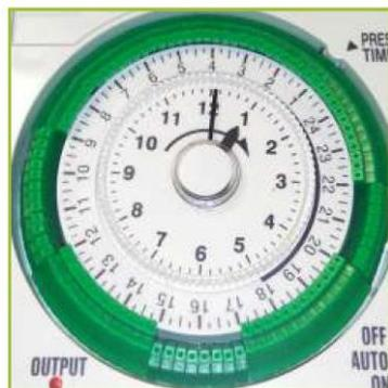
La programmation indiquée permet une connexion de la charge associée pendant les intervalles de temps suivants : de 9 h 00 à 12 h 00, de 15 h 00 à 17 h 00 et de 20 h 00 à 22 h 00.
