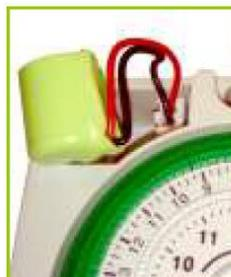
La batterie externe en nickel-hydrure métallique permet au programmateur de continuer à fonctionner même en cas de coupure électrique.
