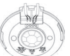
Os cabos entram e saem pela lateral.
