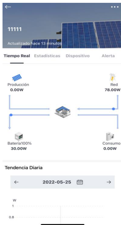
Visión general de la APP Diagrama de flujo con producción, consumo, red y acumulación (si se tiene)
