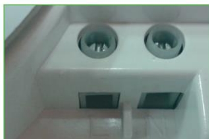
Bornas para la conexión del cableado
