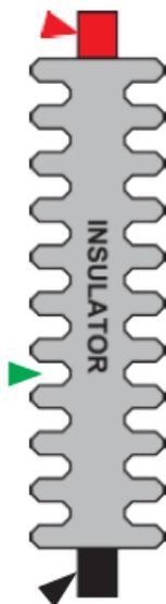
**Conexión de la fase viva (terminal de prueba), cable rojo**
