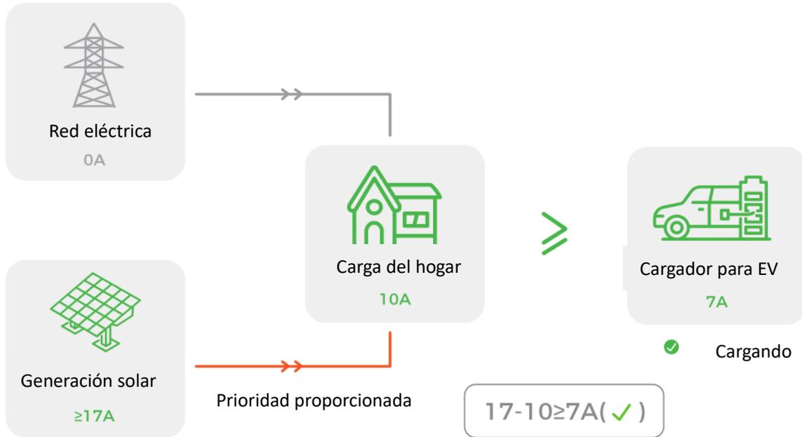
Cuando la energía solar es mayor que la carga del hogar en tiempo real y la corriente residual es más de 7A, el cargador funcionará por la corriente solar disponible. Ninguna corriente proviene de la red eléctrica.
