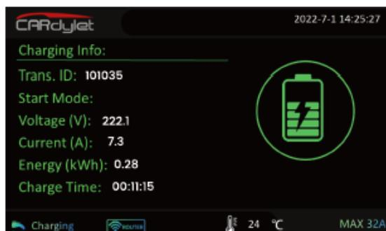
Mientras se está realizando el proceso de carga, la pantalla muestra datos de energía, tiempo de carga, tensión y corriente.
