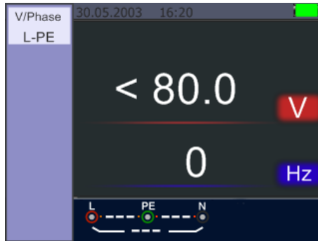
Figura 19 Pantalla de espera para la tensión y la frecuencia
