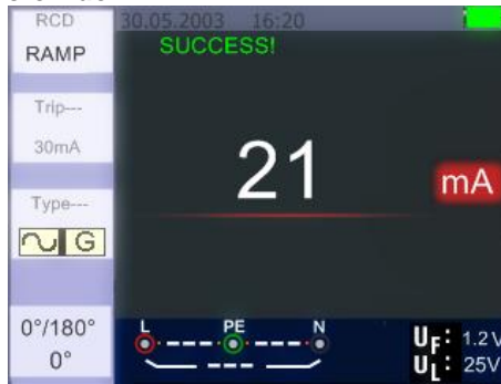
Figura 18. Rampa RCD – Pantalla de medición
