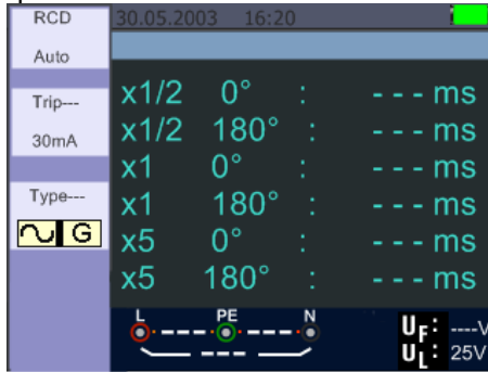
Figura 14. RCD – Pantalla de espera
