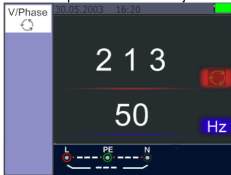
Figura 24 Secuencia de fase – Al conectarse en sentido antihorario
