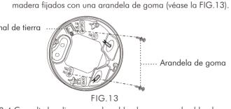
en la superficie de la placa del techo con 2 tornillos para
