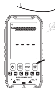
Medición de tensión sin contacto
