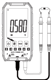
Modo de medición manual de diodo
