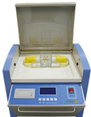
El **KRD-01** es un medidor de rigidez dieléctrica destinado a la comprobación del estado del aislamiento interno de un equipo, que normalmente será un aislante líquido como es el aceite
