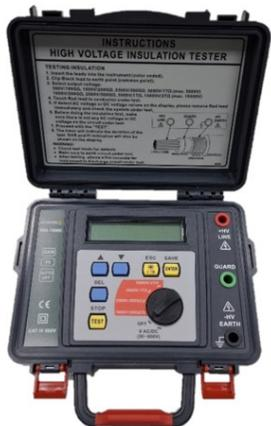
El medidor de aislamiento **KRA-10000** está diseñado para realizar medidas de resistencia de aislamiento en cables y transformadores.
