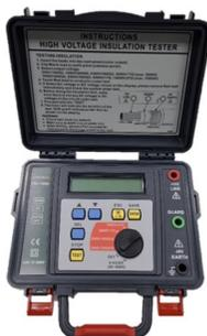
Medidor de aislamiento 10kV
