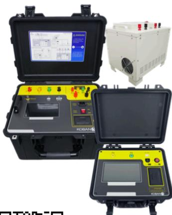
El medidor de paso y contacto está diseñado para medir las tensiones de paso y contacto que puedan aparecer en un centro de transformación, subestación ó una línea de alta tensión. Además ofrece la posibilidad de calcular la resistencia de la tierra a comprobar.
