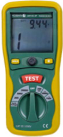
El **KRT-01-4P** es un medidor de resistencia de tierra digital (telurómetro) a 3 hilos con categoría de empleo CATIII 1000V. Destinado a mediciones de resistencia a tierra, tensión AC/DC, resistividad del terreno y continuidad. Dispone de pantalla retroiluminada así como de otras funciones.
