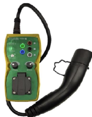
**Existe la posibilidad de adquirir el KIT E.V. para la comprobación de estaciones de carga (EVSE)**
