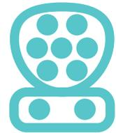
Es la solución propuesta por la Unión Europea para las recargas en corriente continua. Consta de 5 bornes para corriente, protección a tierra y comunicación con la red.
